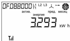
Рисунок 2.7 – Меню 1 Кадр 6. Энергия активная нарастающим итогом всего за предыдущий месяц, в кВт·ч
