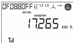
Рисунок 2.6 – Меню 1 Кадр 1. Энергия активная нарастающим итогом всего, в кВт·ч
