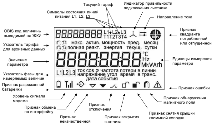
Рисунок 2.3 – Расположение информации на индикаторе
