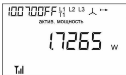
Рисунок 2.9 – Меню 10 кадр 1. Мощность активная всего, в Вт
